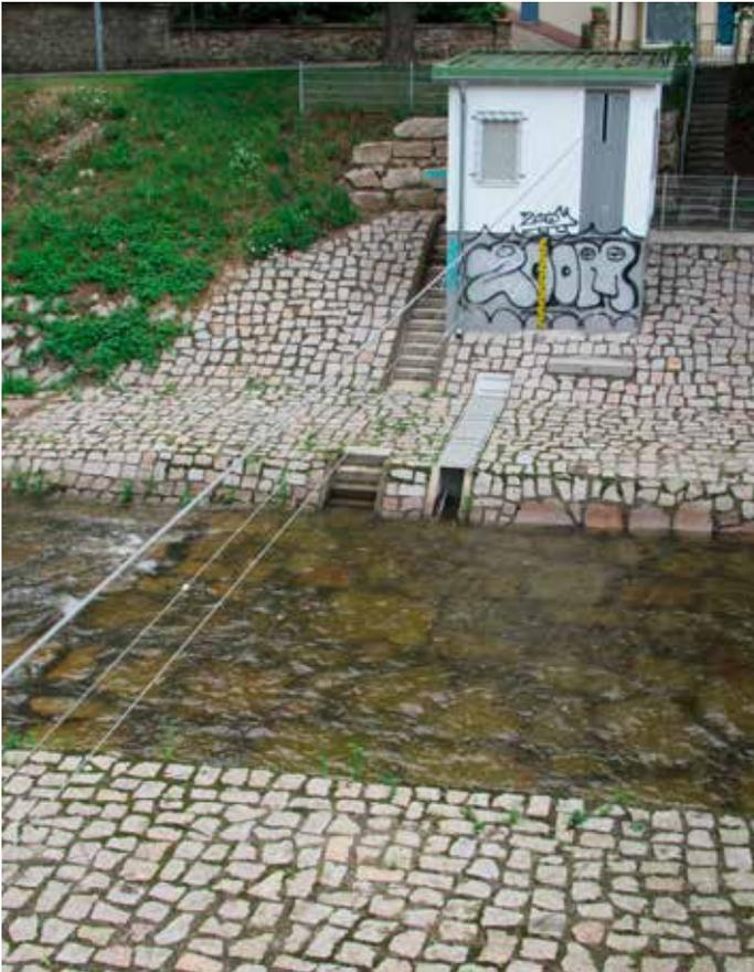
**Die Messstation an der Nepomuk-Brücke - zu sehen sind die Seile für die Krananlage, die die Fließgeschwindigkeit messen kann.**
