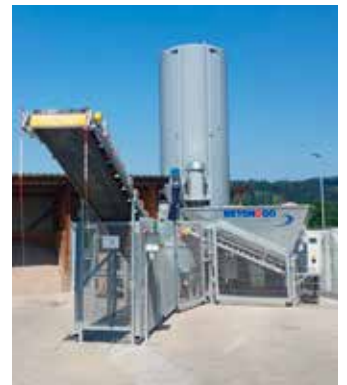
Baustoff-Kiosk mit Touch-Screen für die Betonauswahl, und die Betontankstelle mit dem Förderband.
