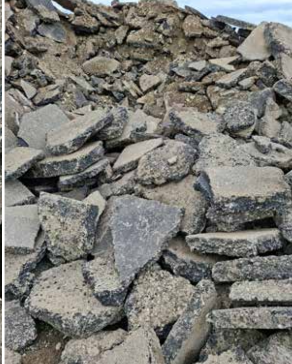
Foto1: Detector-Spray auf neu angelegtem Radweg Kappler Straße. Foto 2: Eindeutige Gelbfärbung auf Teerrest in einem Container. Foto 3: Großer Haufen mit Bitumenbrocken am Kappler Knoten auf dem Platz, der als Lagerplatz für Schüttgut ausgewiesen ist.
