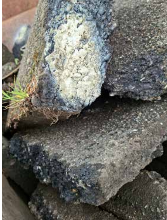
Foto1: Detector-Spray auf neu angelegtem Radweg Kappler Straße. Foto 2: Eindeutige Gelbfärbung auf Teerrest in einem Container. Foto 3: Großer Haufen mit Bitumenbrocken am Kappler Knoten auf dem Platz, der als Lagerplatz für Schüttgut ausgewiesen ist.
