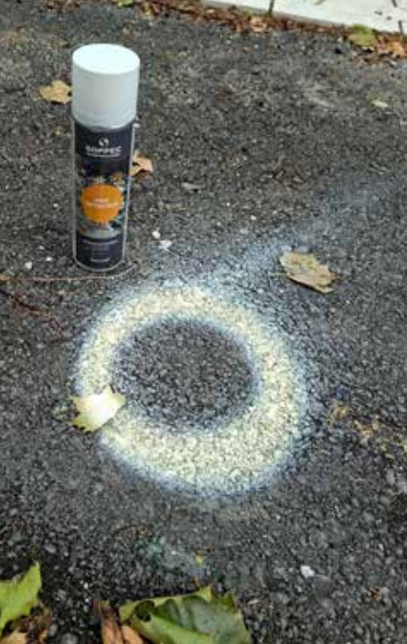
Foto1: Detector-Spray auf neu angelegtem Radweg Kappler Straße. Foto 2: Eindeutige Gelbfärbung auf Teerrest in einem Container. Foto 3: Großer Haufen mit Bitumenbrocken am Kappler Knoten auf dem Platz, der als Lagerplatz für Schüttgut ausgewiesen ist.
